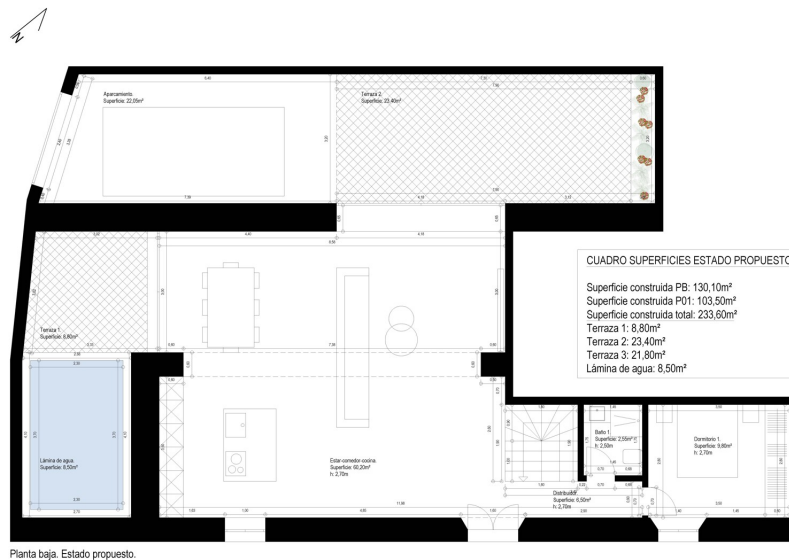
Planta baja. Estado propuesto.
