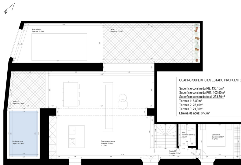
Planta baja. Estado propuesto.
