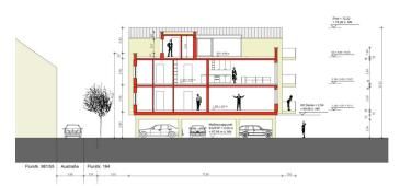
Schnitt 1-1 mit Flachdach im Bereich der Wohnungseingänge im DG
