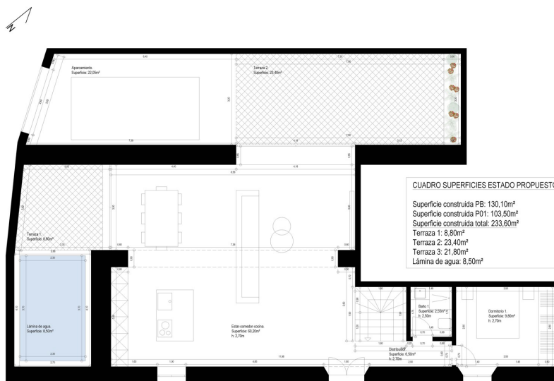
Planta baja. Estado propuesto.
