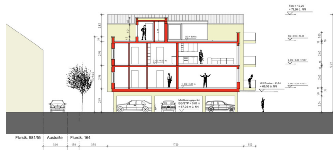
Schnitt 1-1 mit Flachdach im Bereich der Wohnungseingänge im DG
