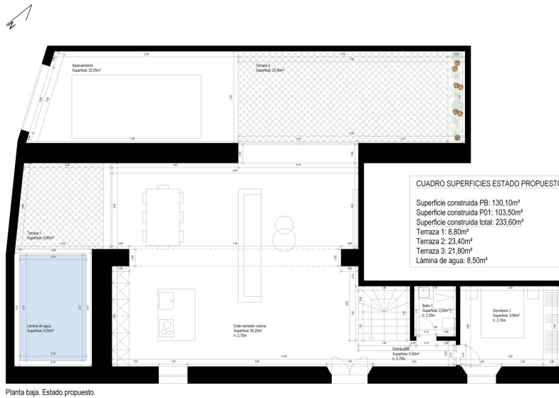
Planta baja. Estado propuesto.
