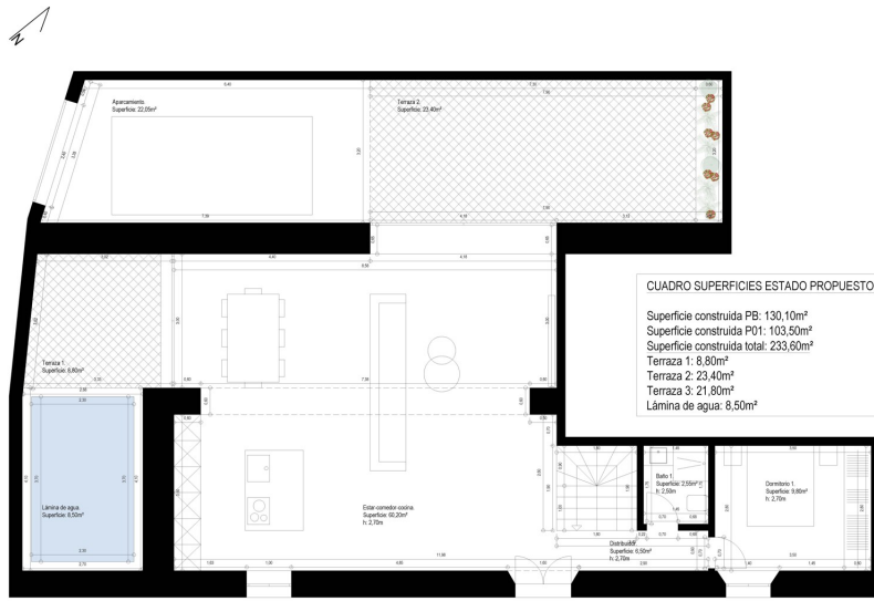
Planta baja. Estado propuesto.
